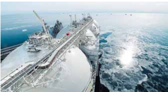
Flüssige Energie: Kugeltankschiffe transportieren das LNG rund um den Globus.
