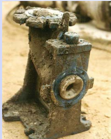
Fußkrümmer DN 80 der Pumpe 2 nach 319 Betriebsstunden und Saugstutzen nach 180 Betriebsstunden des Zentratpumpwerkes
