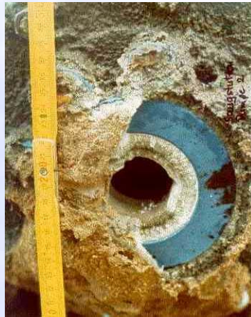
Fußkrümmer DN 80 der Pumpe 2 nach 319 Betriebsstunden und Saugstutzen nach 180 Betriebsstunden des Zentratpumpwerkes
